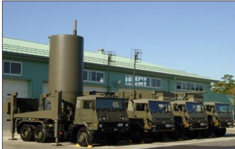
移動式警戒管制レーダー (上空の航空機等を探知追尾)
